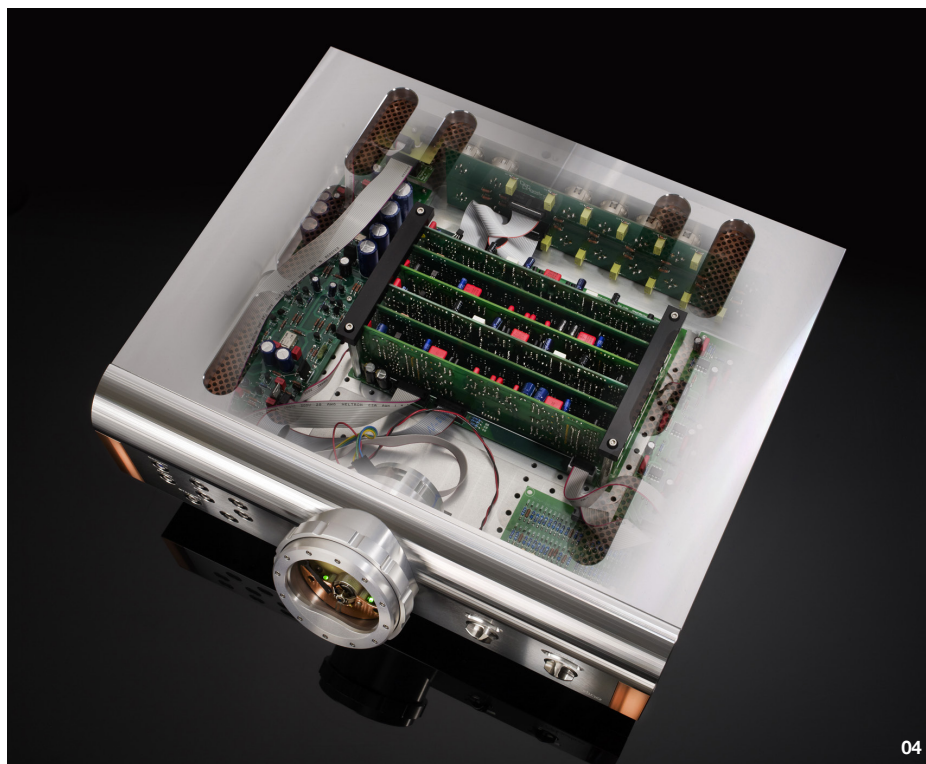
04. Momentum HD的內部中央有六塊直立的線路板、左右二邊還各有一塊平躺，這二塊是電源供應線路板。前方還有一小塊佈滿電阻的線路板，那就是獨立的Tone Control線路板。
